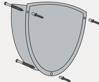
> Befestigung an der Wand durch mitgelieferte Dübel und Schrauben
