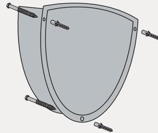
> Befestigung an der Wand durch mitgelieferte Dübel und Schrauben
